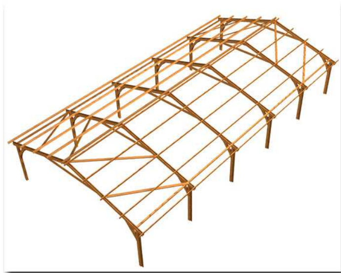
Figure 2 : Bâtiment Noétech réalisé à partir d'un portique simple, à angle rigide
